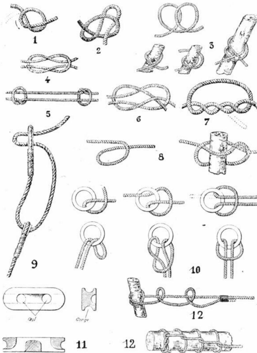
1. Nœud simple. — 2. Nœud simple gansé. — 3. Nœud de batelier. — 4. Nœud droit. — 5. Joint anglais. — 6. Nœud de tisserand. — 7. Nœud double. — 8. Nœud de galère. — 9. Usage d'une cosse de réglage. — 10. Amarrage en tête d'alouette. — 11. Cosse de réglage et sa coupe. — 12. Amarrages par demi-clefs.
