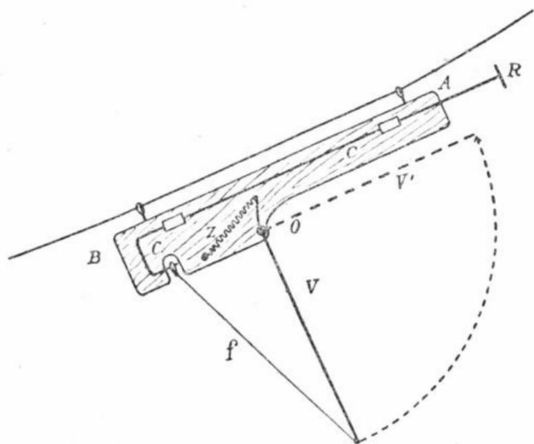
qu'elle est par le vent qui presse une voile V : celle-ci est maintenue normale au vent par une ficelle *f* dont l'extrémité porte un anneau *a*, retenu par un crochet *c* terminé par une rondelle R.
