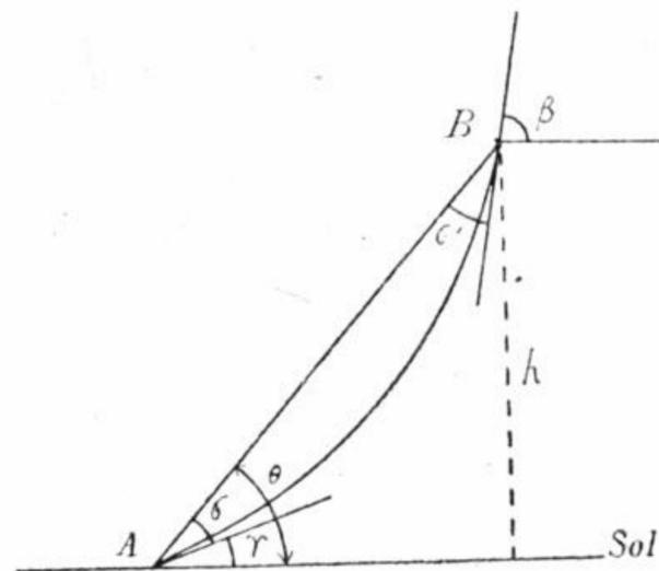
Sous l'action du vent, la corde de retenue prend une forme plus courbée que celle de la chaînette et devient très sensiblement un arc de cercle (Cap. Saconney).
