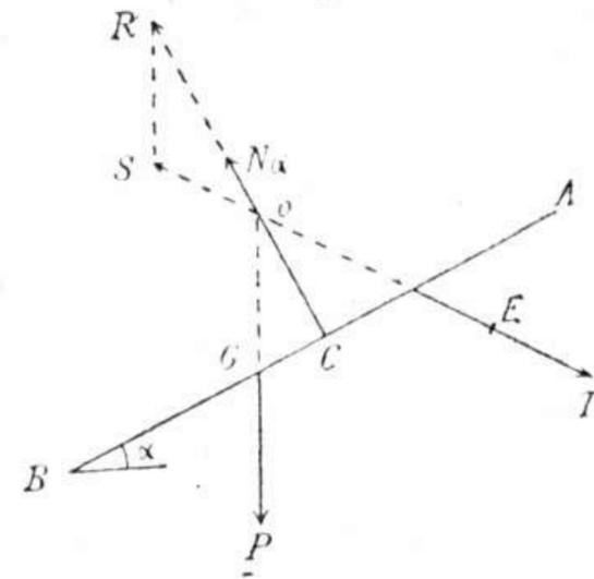
*Triangle des forces.* — Le cerf-volant, étant en équilibre dans l'air, est soumis à l'action de trois forces concourantes dont la résultante est nulle, ou ce qui revient au même, une de ces trois forces est la résultante des deux autres.
