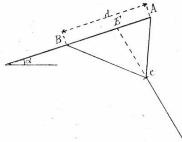
ment  $\alpha$  voisin de  $15^\circ$ , et l'on tend la bride avec le doigt, de façon à amener le sommet C en un point tel que la direction supposée de la traction de la corde de retenue vienne en un point E compris entre A et B, à une distance du bord d'attaque que l'on aura déterminée approximativement par la construction du *triangle des forces* (voir: aérodynamique). On fait une boucle en ce point C et on y fixe un *gabillot*.
