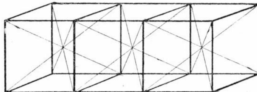
lant à la flexion). Les traits fins indiquent les haubans (travaillant à la traction).
