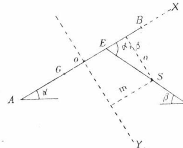
Bridage du cerf-volant. — Le sommet de la bride a pour coordonnées  $m$  et  $n$  par rapport aux axes OX et OY, le centre de figure O étant pris comme origine, et la longueur OB étant prise pour unité de longueur.
