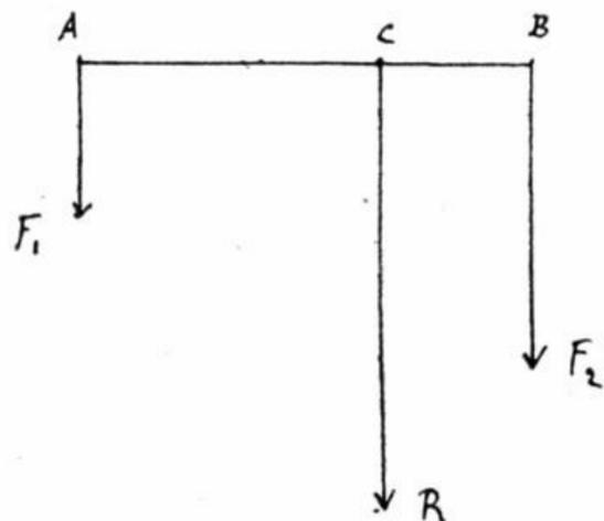
S'il y a plus de deux forces, on compose d'abord  $F_1$  et  $F_2$ , puis leur résultante  $R_1$  avec  $F_3$ , ce qui donne  $R_2$ ; on compose ensuite  $R_2$  avec  $F_4$ , etc.
